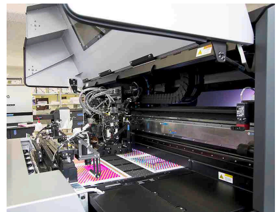
Die Scodix S75 in Aktion: Mit dem Veredlungssystem werden die Druckbogen im Format B2+ (Doppelnutzen) spotlackiert.
